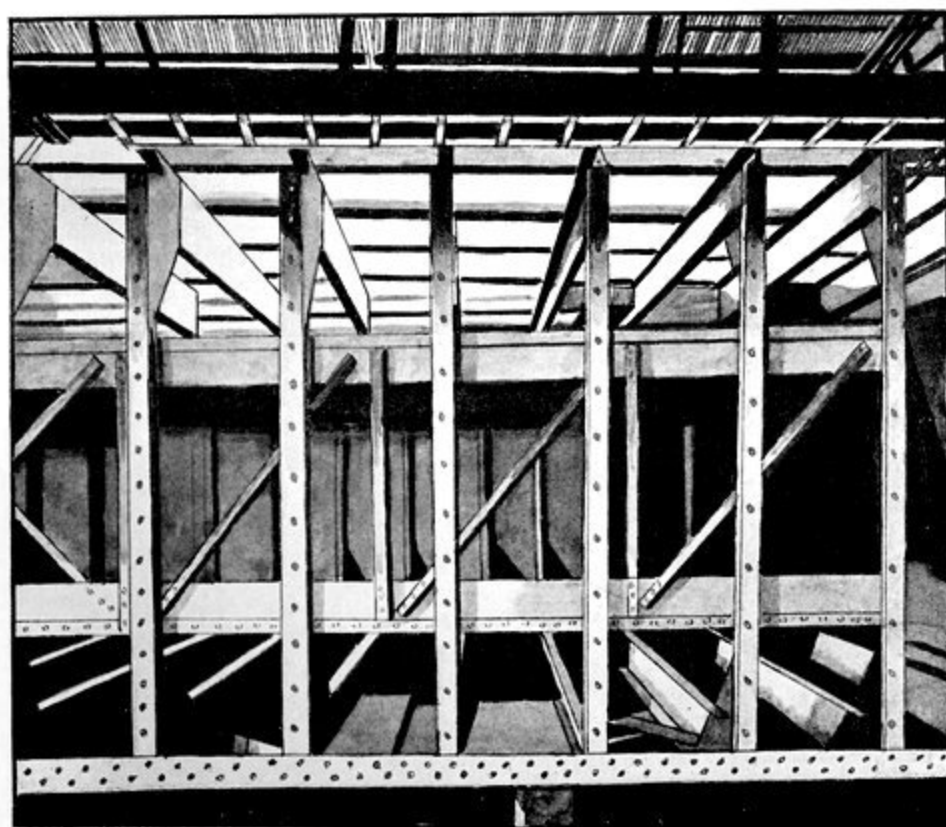
В. Стальные связи, донные и палубные лежни 8-футовой драги.
