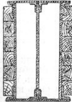
Черт. 7: попер. сечение свай с середанн. ребром.
