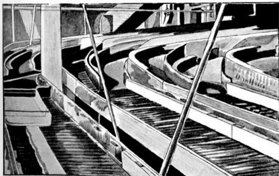
В. Золотоулавливающие плоскани и шлюзы на драге Конрей № 4.
