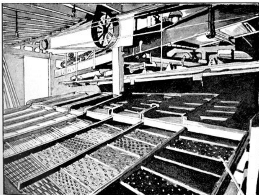
В. Качающиеся решетки и плоскани, драга Юнион, фольсомское месторождение, Калифорния.
