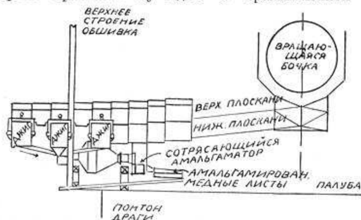
Черт. 20. Попер. разрез, показ. установку джагов, мельницы Гардинга и Альтагаматора на Иосемит. драге.
