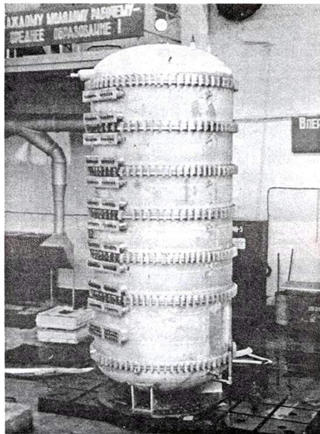
Колонна обсорбционная для технологических линий переработки
